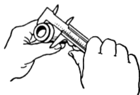
Obr. 70. Měření posuvným měřítkem. Zvláště si všimněme držení součásti a měřítka.
