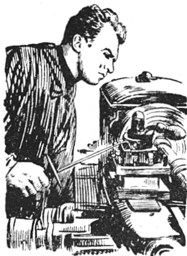
Obr. 147. G. Bortkevič, soustružník ze Sverdlovova závodu v Leningradě, vyznamenaný Stalinovou cenou za zavedení rychlostního soustružení. Všimněme si háčku k odstraňování třísek.
