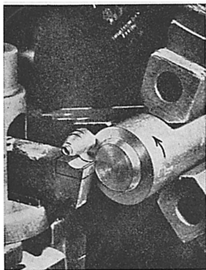
Obr. 129. Vlevo je nůž s karbidovým břitem při obrábění oceli, vpravo při soustružení litiny. Destička slinutého karbidu je k násadě nože připájena mědí. Všimněme si tvaru čela nože, po němž ubíhá tříska. Napřed je úzká ploška, nazvaná fasetka, potom vybroušený žlábek. Tento tvar nožů objevili a zdokonalili sovětsští stachanovci, kteří tak našli nástroje pracující opravdu rekordní rychlostí. Na oceli se tříska svinuje, někdy jí však stavíme do cesty výstupek, nazvaný lamač třísky, který láme třísku na kousky. Na litině se tříška drobí na malé kousky a v prach. Na ocel je proto nutný jiný tvrdý kov, u nás nazvaný diadur S1, S2, S3. Na litinu je tvrdý kov značek G1, H1. Všechny značky vyrábí Poldina huť v Kladně.
